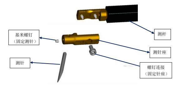
图 2 分体式测针连接
