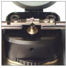
Ø3 mm 支撑台带有微调旋钮,通过 S233Mini千分表显示高度值
